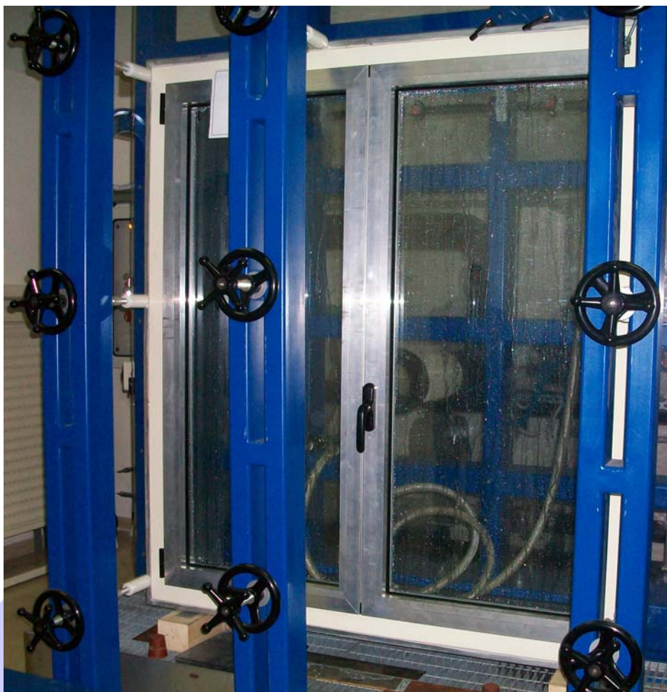
Foto 2: Campione sottoposto a prova durante la prova di tenuta all'acqua
