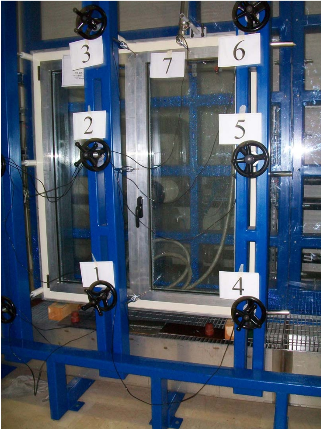
Foto 3: Campione durante la prova di resistenza al vento (prova di deformazione)
